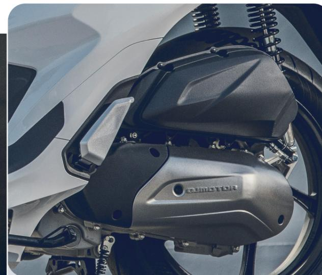
**MOTOR MONOCILÍNDRICO 125 CC DE 4 VÁLVULAS** con refrigeración líquida e inyección electrónica, que ofrece una potencia de 15 CV a 8.500 rpm y entrega un par máximo de 12 Nm a 6.500 rpm.
