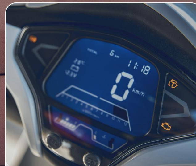
**DASHBOARD LCD** digital con toda la información relevante en un vistazo: velocidad, cuentarrevoluciones, nivel de combustible, odómetro, hora, testigo TCS, sensor de caballete lateral, etc.
