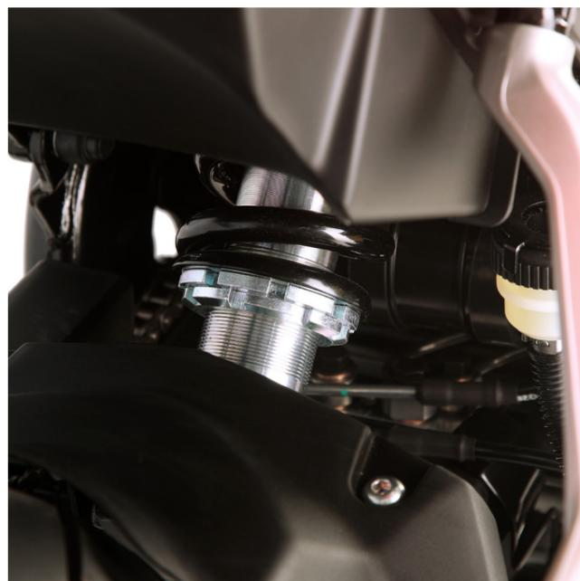
↑ **Suspensiones con horquilla invertida** de 43 mm en el tren delantero y monoamortiguador regulable en precarga de muelle en el tren trasero.
