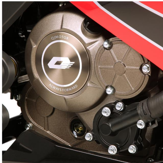
↑ **Motor monocilíndrico 125 cc de 4 válvulas** con refrigeración líquida, con una potencia de 15 CV (11 kW) que entrega un par motor máximo de 12,1 Nm a 7.000 rpm contando con un sistema de inyección electrónica.
