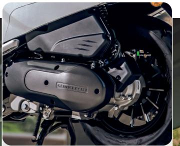
MOTOR MONOCILÍNDRICO 125 CC DE 4 VÁLVULAS con refrigeración líquida e inyección electrónica, que ofrece una potencia de 15 CV a 8.750 rpm y entrega un par máximo de 12 Nm a 8.250 rpm.
