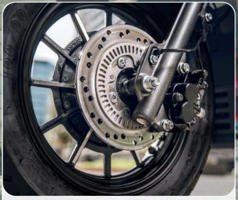
**SISTEMA ABS DE DOBLE CANAL** con frenos de disco de 220 mm en rueda delantera y disco de 190 mm en rueda trasera.
