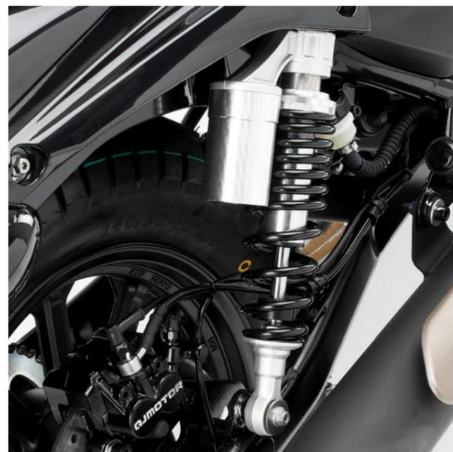
↑ **Suspensiones con doble amortiguador** de 60 mm de recorrido regulable en precarga en tren trasero y horquilla telescópica convencional de 118 mm de recorrido en tren delantero.
