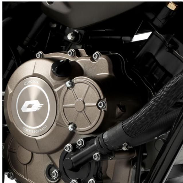
↑ **Motor monocilíndrico 125 cc** con refrigeración líquida, con una potencia de 14,9 CV (11 kW) que entrega un par motor máximo de 12,1 Nm a 7.000 rpm contando con un sistema de inyección electrónica.
