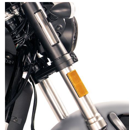
HORQUILLA INVERTIDA DE 48 MM. RECORRIDO 125 MM. Y DOBLE AMORTIGUADOR REG. EN PRECARGA
