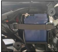
F. retire la correa de la batería y extraiga la batería con cuidado.
