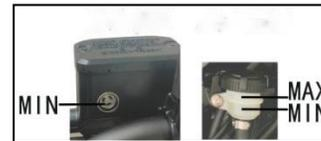
bajo que la línea de grabado MIN (o LOWER), se debe agregar el líquido de frenos especificado. El líquido de frenos suplementario se debe considerar necesario para el mantenimiento regular.
