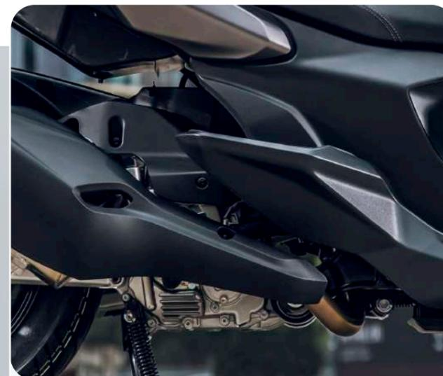
**MOTOR MONOCILÍNDRICO 350 CC DE 4 VÁLVULAS** con refrigeración líquida e inyección electrónica, que ofrece una potencia de 34 CV a 7.500 rpm y entrega un par máximo de 35,5 Nm a 6.000 rpm.
