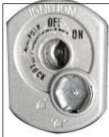
Marca «ON»: Gire la llave a la posición marcada «ON», la moto se enciende, el motor se puede arrancar y la llave no se puede sacar.
