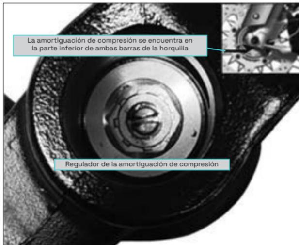
La amortiguación de compresión tiene  $23 \pm 2$  niveles. Girando el tornillo central en sentido horario (H) se aumenta la amortiguación y en sentido antihorario (S) la amortiguación disminuye. Para ajustar la amortiguación de compresión estándar, siga estos pasos:
