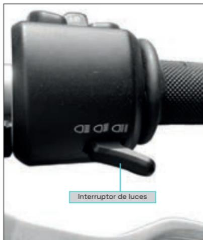
**Interruptor de luces:** El interruptor de las luces está instalado en el interruptor combinado de la izquierda.
