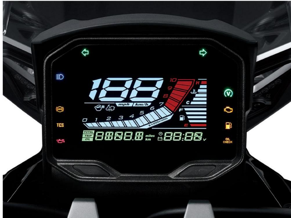
Dashboard de 4.3" a color con toda la información relevante además de sensor de pata de cabra y apertura de asiento visible en display.
