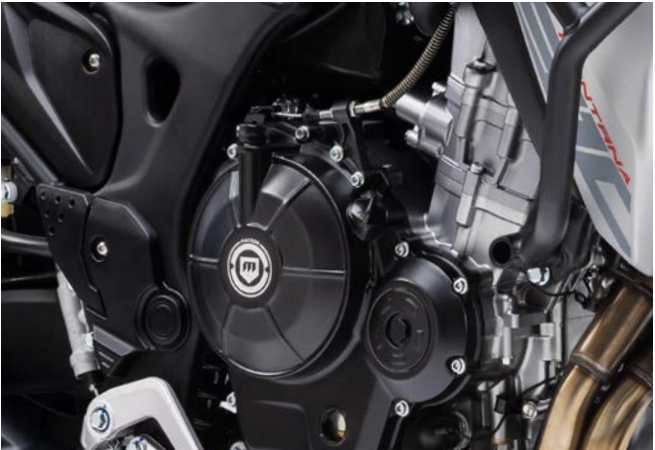
MOTOR BICILINDRICO 4 TIEMPOS, 8 VALVULAS, 498 CC, 47 CV / EMBRAGUE ANTIRREBOTE
