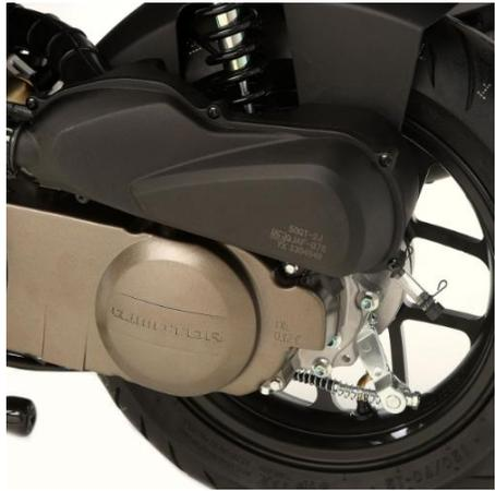
**MONOCILÍNDRICO, 2V, 4T, SOHC,
